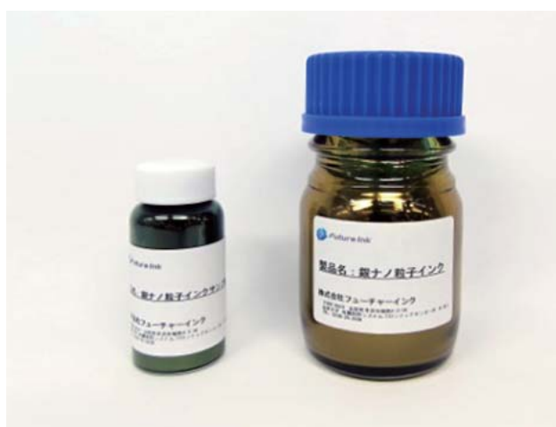
銀ナノインク試作品(左)と銀ナノインク量産品(右)。
