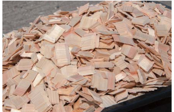
チップの大きさは2mmから15mmまで調整可能。
