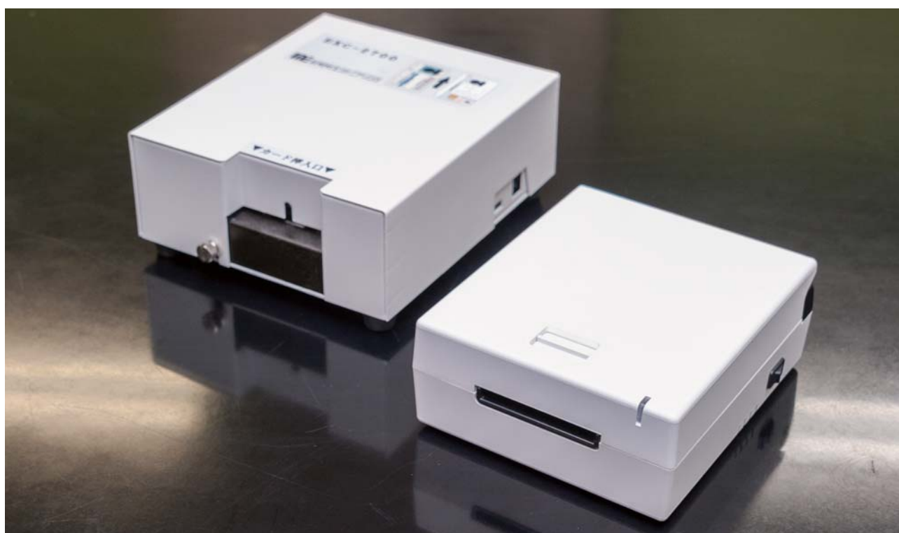
左奥が既存の本人確認装置。右手前が顧客の要望で小型・軽量化した本人確認装置。
