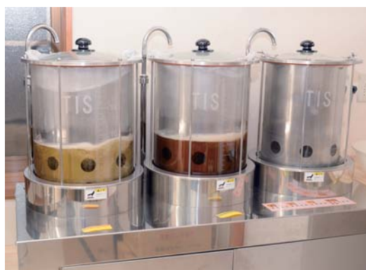
同時に3種の漢方薬を煎じ、パック詰めができる。
