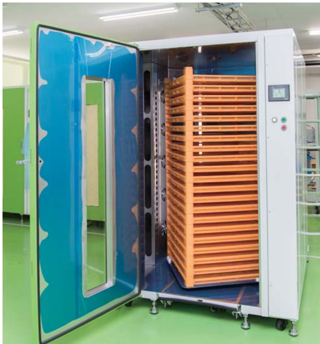
庫内のコンテナを回転させ温度・湿度を均一にする
