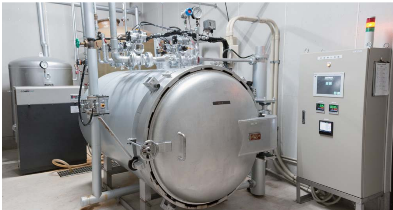
加圧高温殺菌を可能にするレトルト殺菌装置を導入
