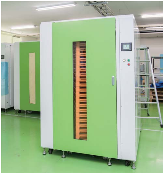
中型常温食品乾燥機の試作機
