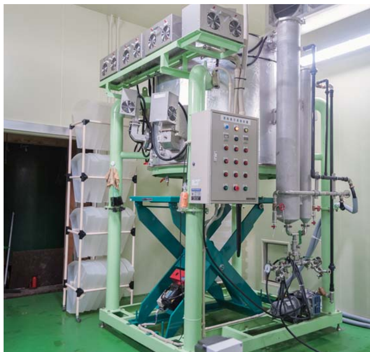
マイクロウェーブ式酒粕減圧蒸留機を導入
