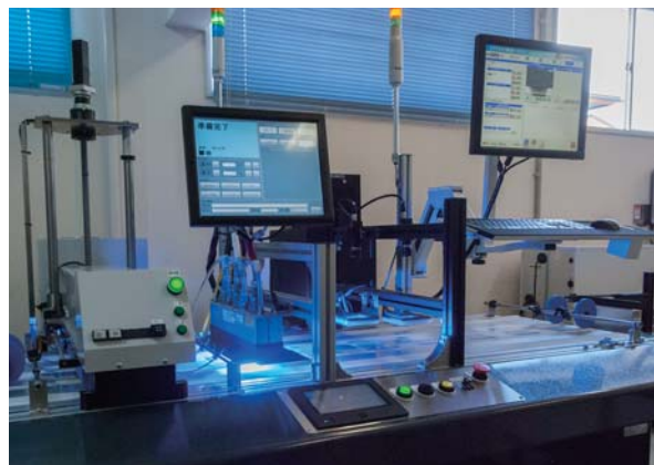
LED速乾機能と2台のCCDカメラで不良を検知
