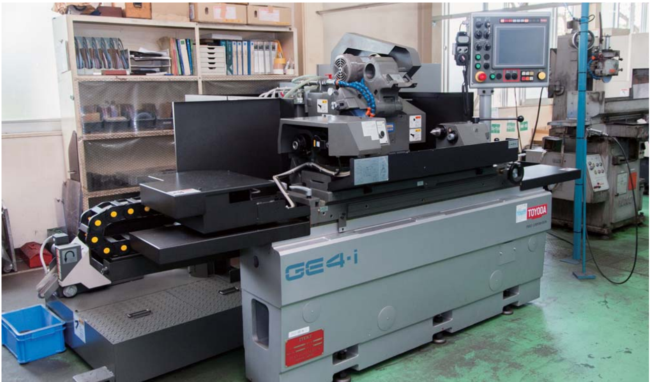
CNC円筒研削盤導入でより精密度の高い丸物部品加工が可能に。
