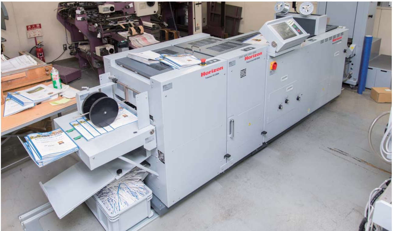
折加工機 外注していた細かい折加工が内製化で可能に。
