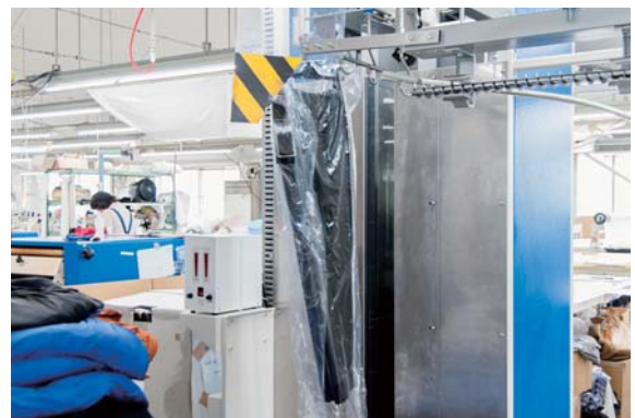
ハンガー式立体検針機 ハンガーのまま検針が可能になり、しわ取り（補正プレス）も不要になった。
