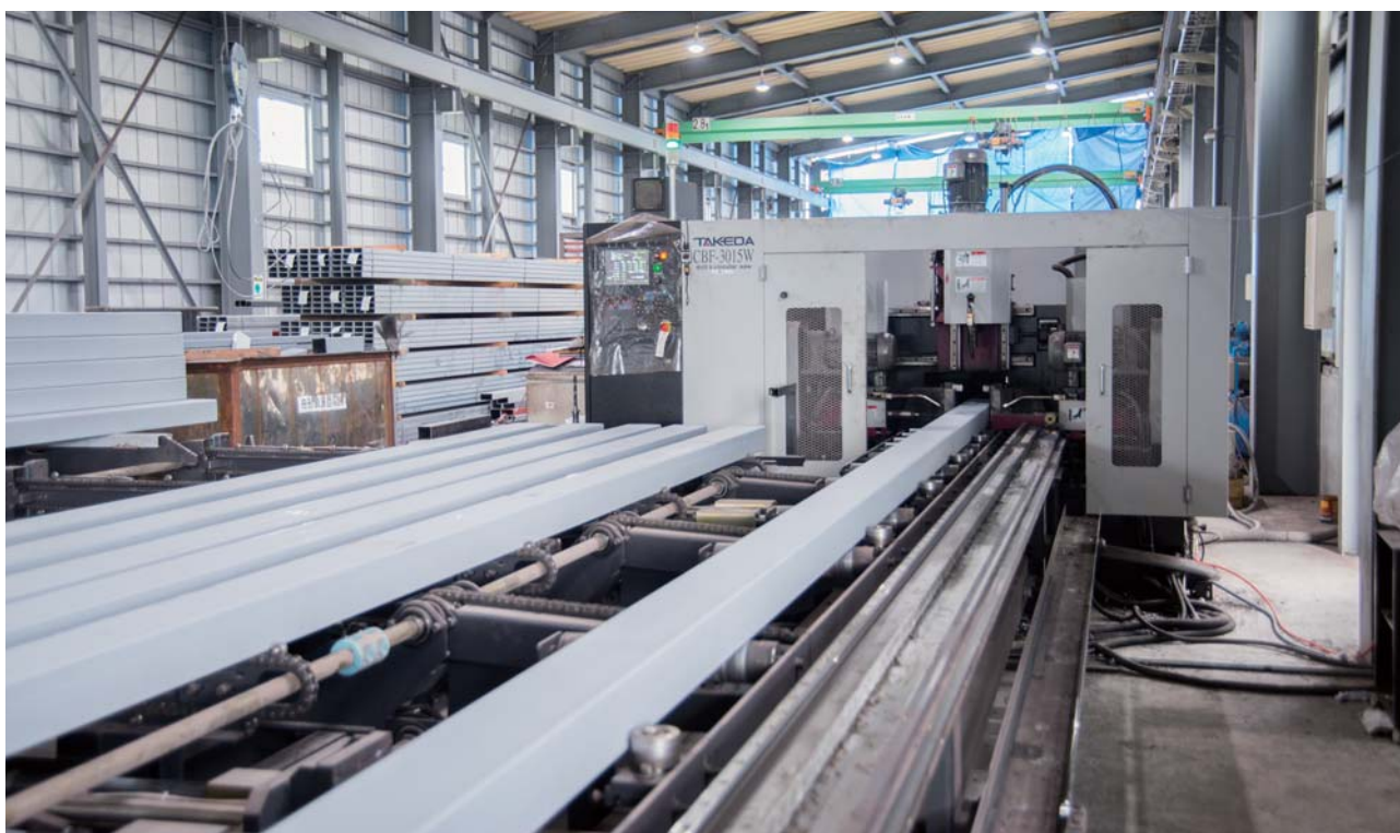
鋼材の孔明け、切断、番号記入が可能。鋼材の種類も多種に対応可能な複合機。
