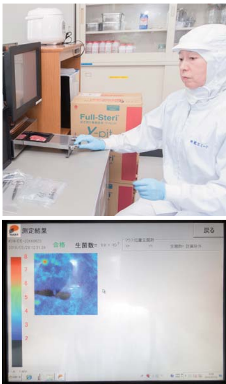
生菌可視化装置は原料を入れるだけでモニターに約1分で表示される。
