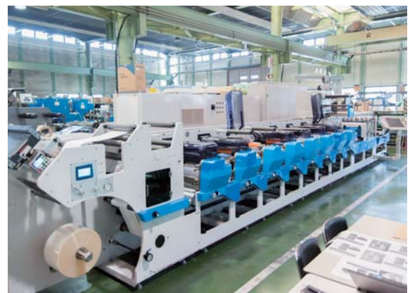
フレキシ印刷機 オペレーションするのがやすく、水溶性インクを使用するため環境にもオペレーターにも負荷が少ない。
