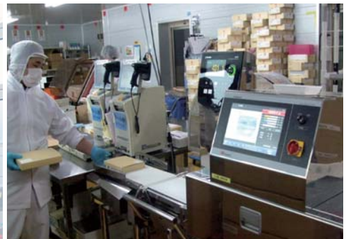
右のX線検査装置で異物混入を検査後自動で、左側のウェイトチェッカー機へ。
