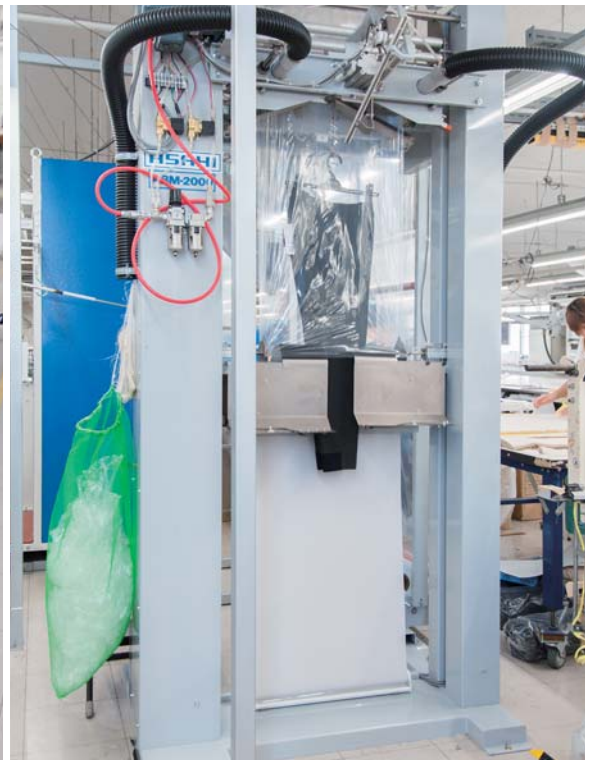
全自動梱包機 ビニール袋の袋掛けが全自動に。 製品の丈によってビニールが自動カットされる。
