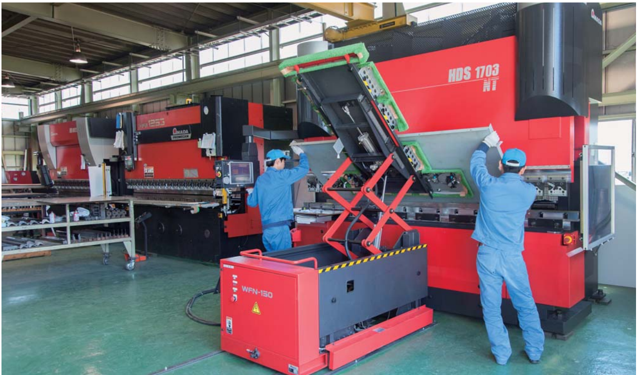
新型ベンドマシン導入でステンレス3mm厚にも対応可能となった。
