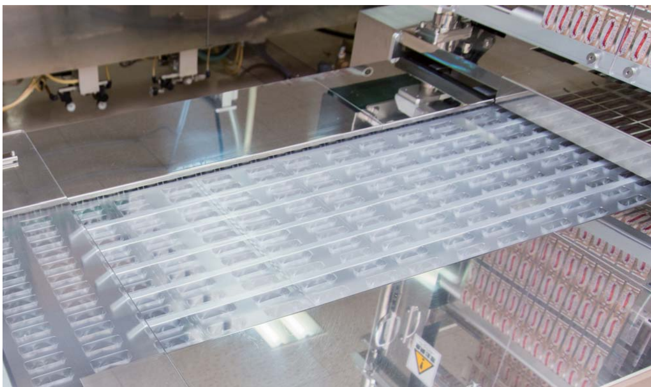
深絞り真空機 小さいサイズのドライソーセージが1本ずつ真空パックされて流れてくる。
