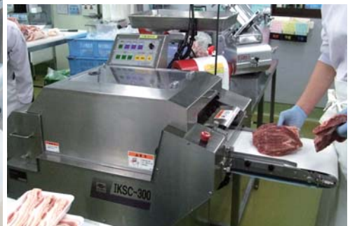
生肉加工工場に導入した、角切機。
